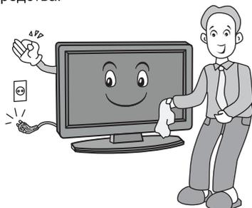
9. Не пренебрегайте безопасностью, используйте поляризованную или заземляющую вилку. Поляризованная вилка имеет два контакта, один шире, чем другой. Вилка заземляющего типа имеет два контакта и один заземляющий штырек. Широкий контакт или третий штырь предназначены для обеспечения безопасности. Если вилка не подходит к вашей розетке, обратитесь к электрику для замены устаревшей розетки.
